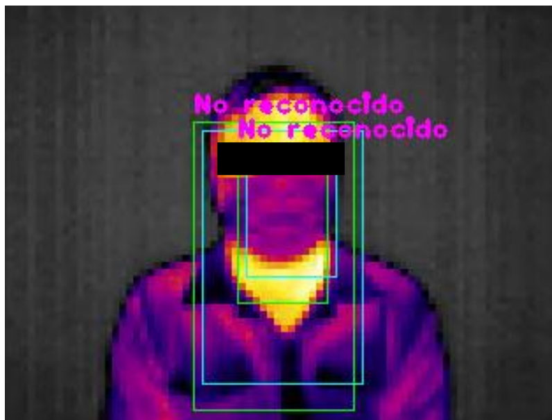
Figura 127. Identificación de rostro erróneo Fuente. Detección de temperatura ejecutado en Termógrafo Embebido.
