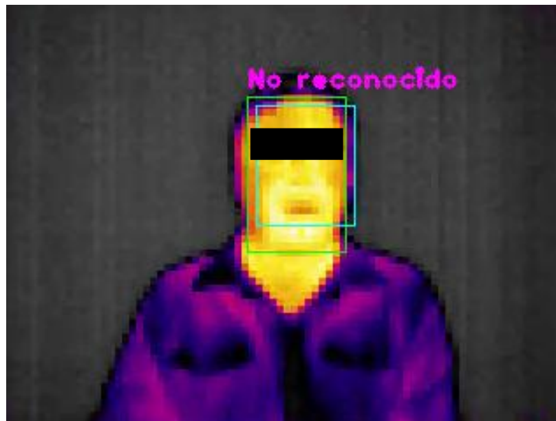
Figura 126. Identificación de rostro térmico en sistema pre-entrenado Fuente. Detección de temperatura ejecutado en Termógrafo Embebido.
