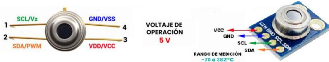
Figura 35. Sensor MLX90614 Fuente. Elaboración propia extraído de (Sparkfun, 2023)
