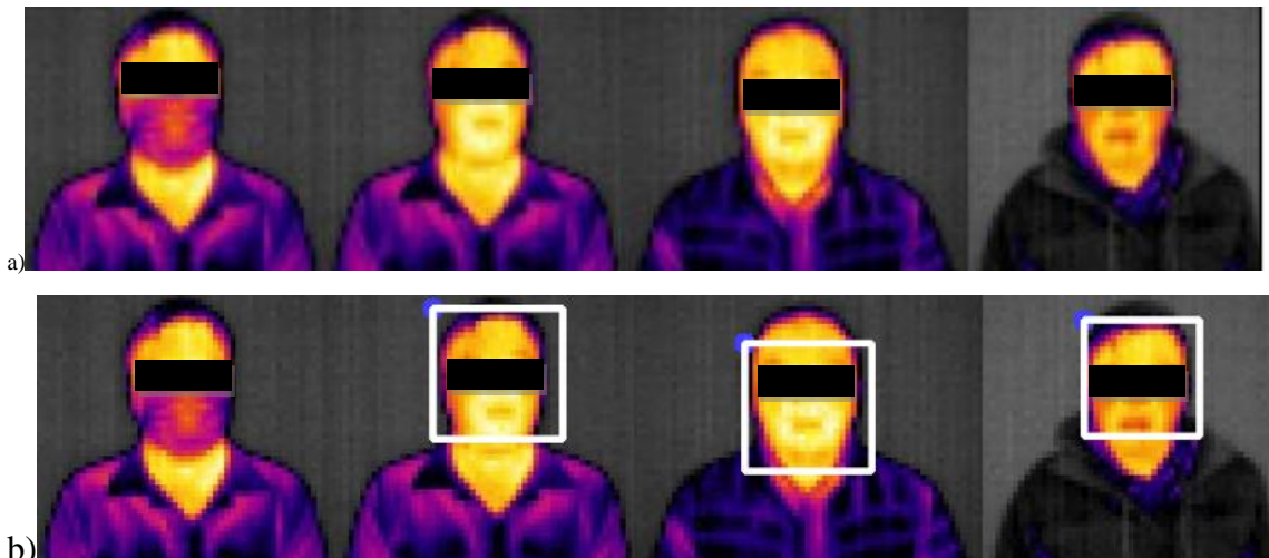
Figura 76. Ejemplo de reconocimiento de 4 rostros en escena térmica Fuente. Elaboración propia con base en la detección de rostro ejecutado en Spyder
