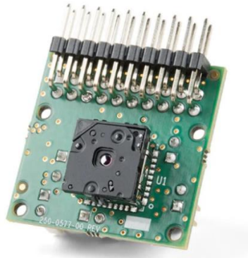
Figura 33. FLIR Lepton® Breakout Board v2.0. Fuente. Extraído de (Flir, 2023)
